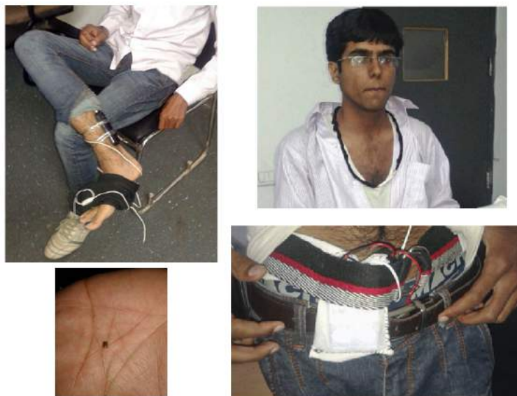
Obrázek 1.6: 19letý Dhruv Kakar při kontrole rozhodčím. Vlevo nahoře telefon připevněný na noze, vlevo dole mikrofon, který byl skrytý v uchu, vpravo nahoře skrytá smyčka kolem krku, propojená k bateriím vpravo dole. [16].
